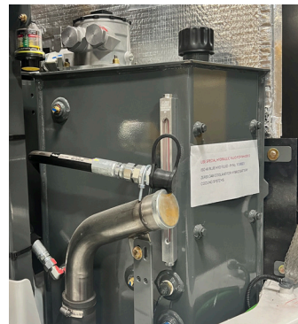
Fig. 67: Hydraulic Tank Fill Cap
